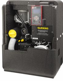
Aspiración progresiva, de 1 a 3 equipos en su versión A., Motor mejorado, más eficiente y potente, para la mejor aspiración del mercado con el consumo más bajo. Potencia rendida: 1.1 kW - 4.8 A. Caudal máximo: 1400 l/min (1700 l/min con password). Presión máxima en servicio continuo: 210 mbar.
