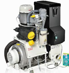
Alcanza 280mbar de presión de vacío con un motor Uni-Jet 75 2 V de dos ventolas en serie y separador de amalgama. La presión elevada permite aspirar por tuberías de diámetro reducido, con una presión normal (170-200mbar) sería insuficiente. Potencia rendida: 1,5 kW - 9 A. Caudal máximo: 1.800 l/min.
