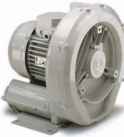
El motor está protegido con una pastilla térmica. Alimentación monofásica: 230V 50hz. Potencia: 0,4 Kw - 3,1 A. Caudal máximo: 1250 l/min. Presión de vacío: 130 mbar. Nivel sonoro: 62 dB (A).
