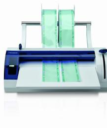
Termoselladora manual con diseño innovador para bolsas y rollos. Motor de deslizamiento en ambos sentidos. Permite definir exactamente la longitud de la bolsa sin malgastar papel. Cuenta con una base de apoyo milimetrada, su banda de sellado es de 12 mm. y su ancho máximo de sellado es de 300 mm.
