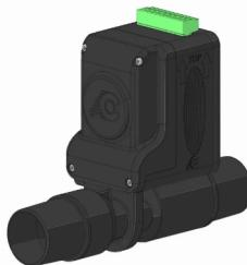
Válvula de corte para sistemas centralizados de aspiración de polvo. Necesita alimentación a 24V y contacto de activación desde un interruptor. Tiene salida a 24V una vez activada y contacto de activación libre de tensión para el sistema centralizado de aspiración.
